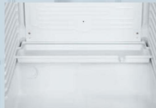
**Кювета для талой воды.** В соответствии с требованиями Директивы ATEX 2014/34/EU в лабораторных устройствах с взрывобезопасным внутренним пространством слив для талой воды, образующейся при оттаивании, герметизирован. Жидкость скапливается в кювете, которую необходимо регулярно осушать вручную.
