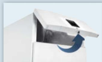
Элементы системы охлаждения надежно установлены в верхней части лабораторного шкафа и легко доступны для обслуживания.
